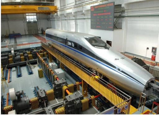
Prueba de rodadura
